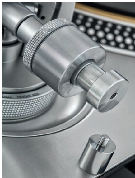
Ramię dostosowano do współpracy z wkładkami o różnej masie. Gdyby standardowa przeciwwaga okazała się niewystarczająca, można ją dociążyć, wkręcając dodatkowe pierścienie.
